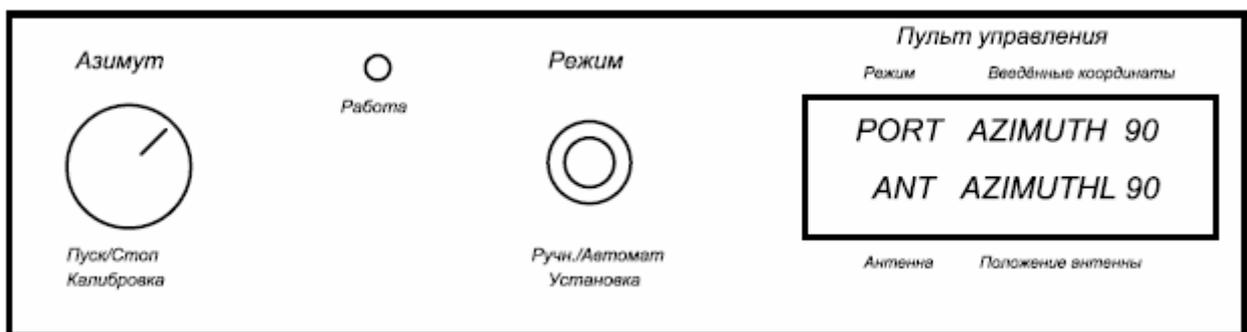
На передней панели расположены ручка управления (энкодер), кнопка, светодиод и ЖК-дисплей. Кнопка «Пуск/Стоп» совмещена с ручкой управления азимутом. На задней панели расположен разъём DB9F, для подключения к СОМ порту компьютера и отверстия для ввода кабелей во внутрь корпуса.
